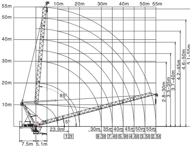
⊗ 臂根铰点 Jib hinge shaft
